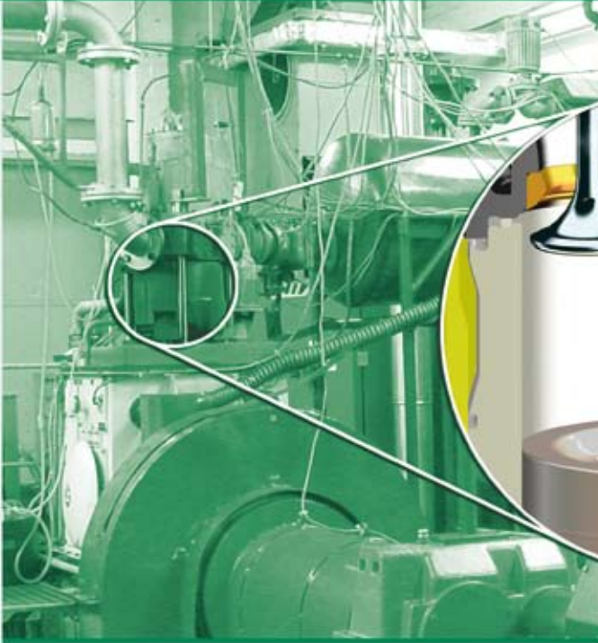
Direkte Wassereinspritzung in einen mittelschnelllaufenden Gasmotor Direct water injection in a medium speed gas engine
